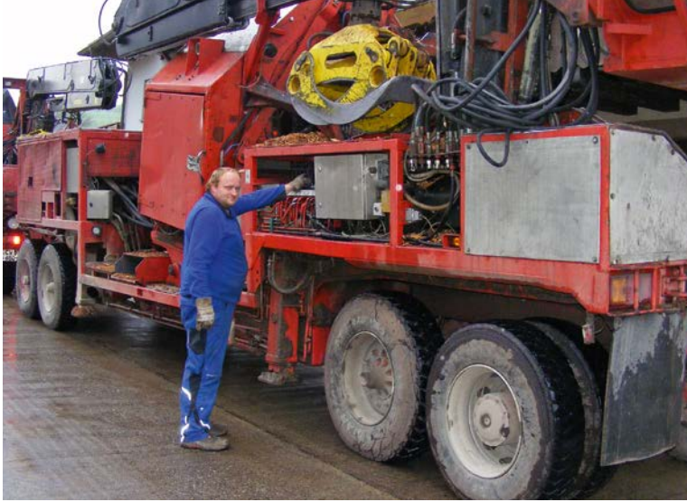
Rangiermanöver rückwärts: René Schneider bedient die hydraulische Lenkung, die synchron auf beide Anhängerdrehkränze wirkt.
