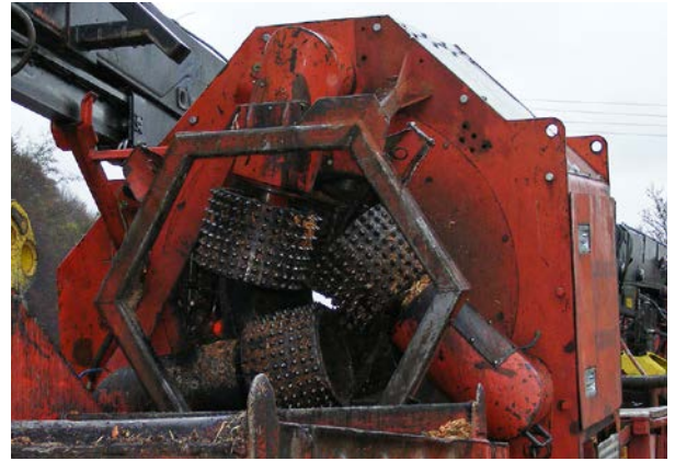
Das dritte Walzensystem am Auslaß des Rambichler-Rotors. Im Stahl-Sechseck sind Komponenten für die Vermessung verbaut.
